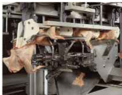
Módulo despellejador de la pechuga.
