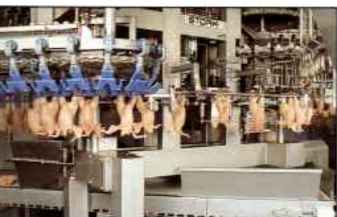
Reenganchador con unidad de pesaje.
