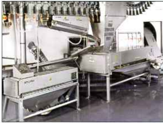
Collectores integrados debajo de la procesadora de mollejas y separadora de corazón y pulmones.
