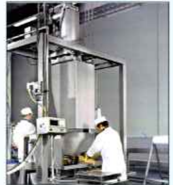
Recogida de piel transportada por vacío desde la línea de fileado.
