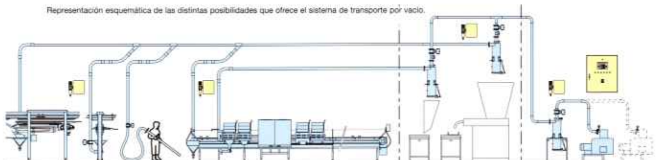
Manguera para la aspiración de subproductos de corte, procedentes, por ejemplo, de la sección de troceado.
