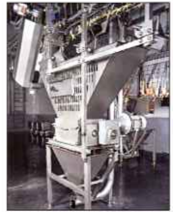
Colector con quebrantador debajo de la estación de descarga de patas.
